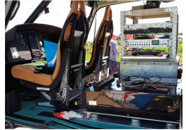
Детекторы спектрометра RSX-500 и блок сбора информации в салоне вертолётa
