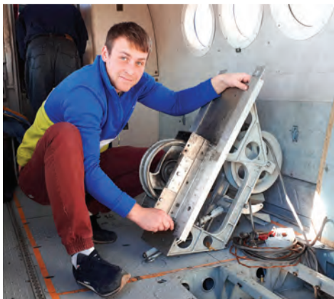
Установка тросорука выпускного устройства
