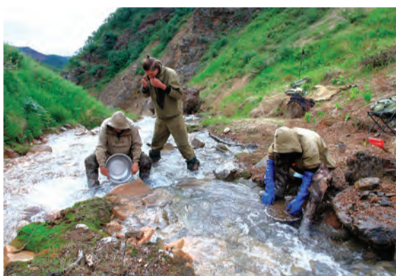
«Шлиховая прачечная». Отбор крупнообъемной шлиховой пробы (фото Аксенова С.В.)
