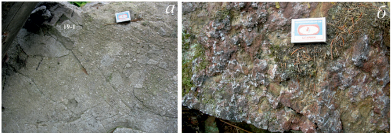
Рис. 2. Агломератовые ксенотуфы участка Чуря (а) и золотоносные брекчии с ячеистой текстурой окварцевания (б). 19-1 – вулканическая бомба риолитов
