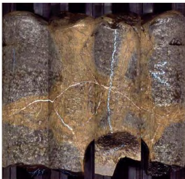
Рис. 218. Изменения в базальтах – карбонатные жилки сопровождаются околожилными смектитом и гидроокислами железа.
