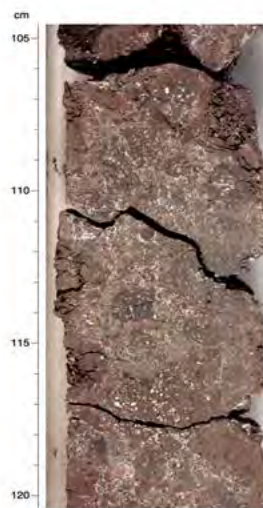
Рис. 73. Красная вулканическая брекчия – верхняя часть потока 6 основания. Обломки превращены в глину – красную и темно-коричневую – и цементируются кальцитом и цеолитом. Рейс 183.
