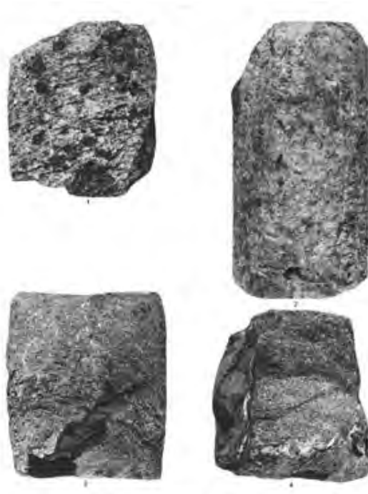
Рис. 101. Пегматиты и гнейсы скв. 330 (1-4), 3 – жилка базитового состава, нацело замещенная смектитом в гнейсе.
