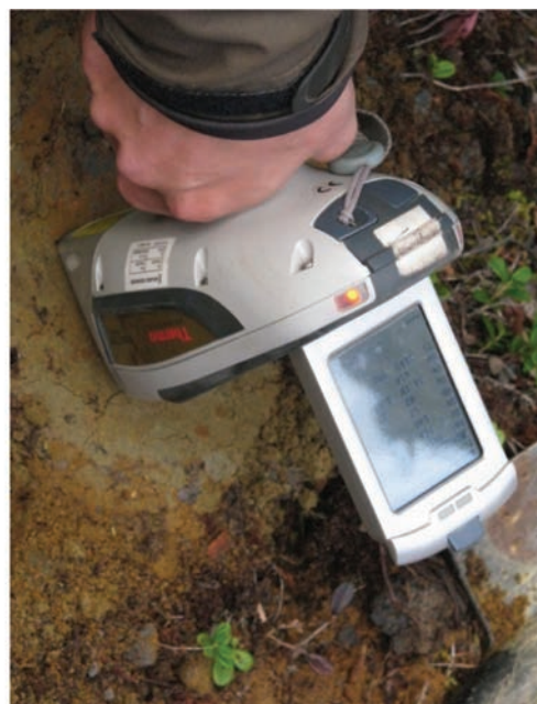
Рис. 1. Анализ почвенных отложений с помощью рентгенофлуоресцентного анализатора. Рудопроявление Карасьок, Норвегия
