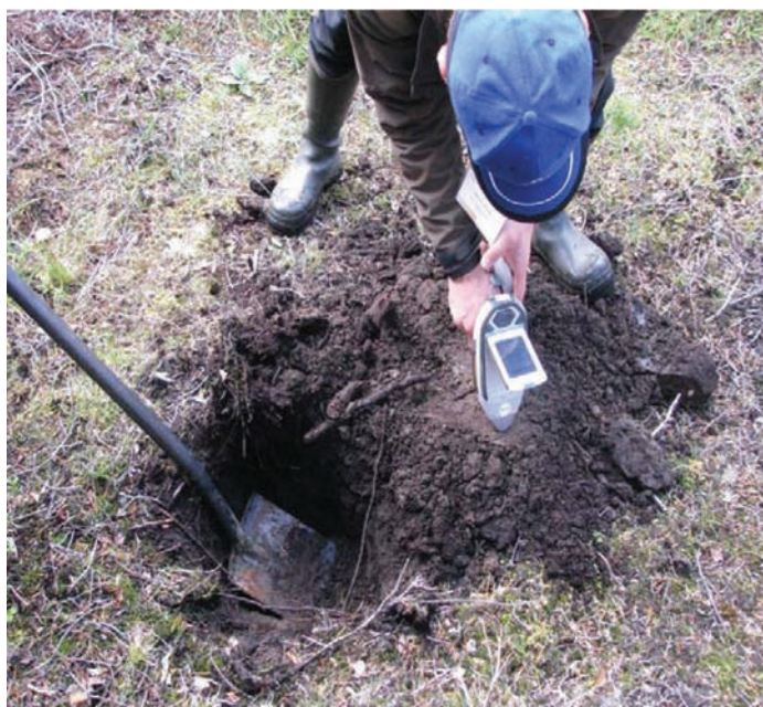
Рис. 1. Анализ почвенных отложений с помощью рентгенофлуоресцентного анализатора. Рудопроявление Карасьок, Норвегия
