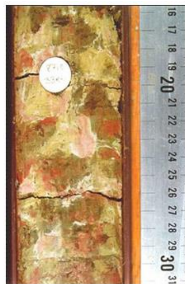
Рис. 1. 529. То же. Следующие 9 м коры выветривания – пятнистые глины – чередование восстановленных и окисленных участков.
