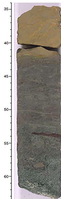
Рис. 1. 62. Граница или контакт между пачкой 48 силифицированной зоны и подстилающим измененным и перекристаллизованным осадком.
