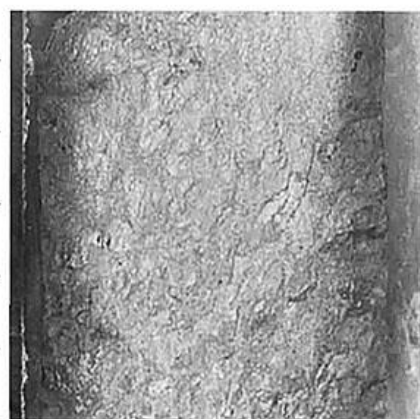
Рис. 1. 650. Брекчированная и карбонатизированная верхняя часть измененного риолитового туфа в основании пачки 4.
