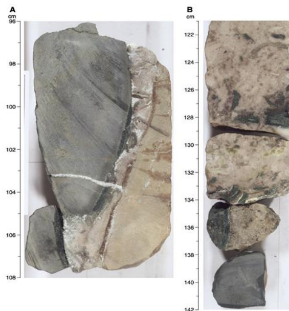
Рис. 1. 74. Верхняя часть базальтового основания в скв. 1179D. Высоко измененный афировый базальт перекрыт коричневым кремнем. Непосредственный контакт осадков и основания не вскрыт (фото слева).
