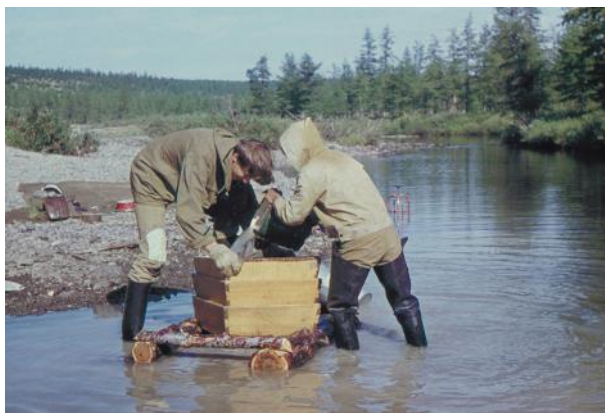
Промывка пробы речных галечников на качающихся ситах, орошаемых водой
