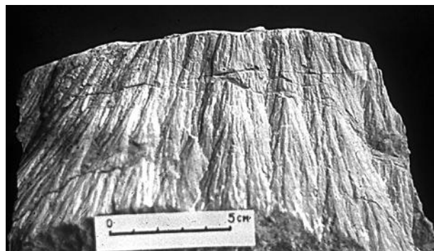
Конусы разрушения в породах имеют вид ельчатых поверхностей
