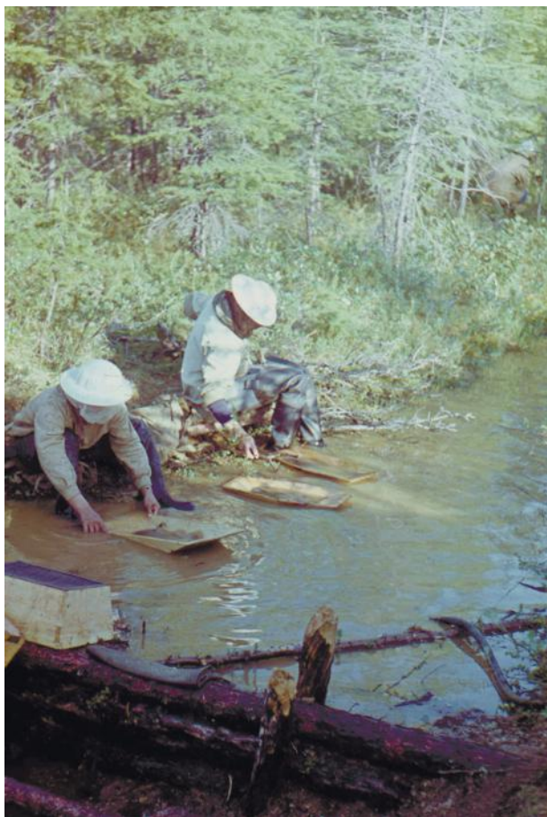
Доводка концентрата обогащения в промывочных лотках
