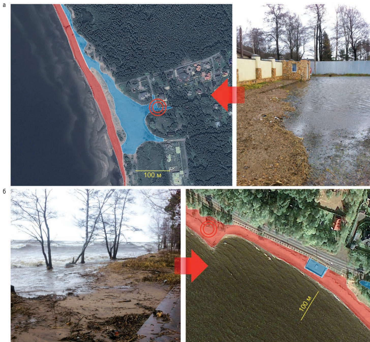
Рис. 49. Зона воздействия шторма на пляж и субаэральную часть береговой зоны: а – в районе станции Александровская; б – в районе променада в пос. Репино. Желтая линия – 100 м. Синяя заливка – зона затока воды, красная заливка – зона активной ударной переработки надводной части береговой зоны волнением.
