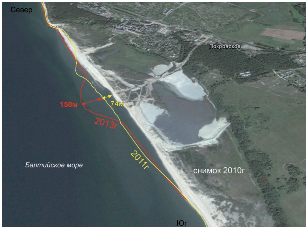
Рис. 135. Динамика изменения береговой линии по результатам повторной GPS съемки в 2013 г. в районе сбросов пульпы и формирования конуса выноса вблизи с. Покровского.
