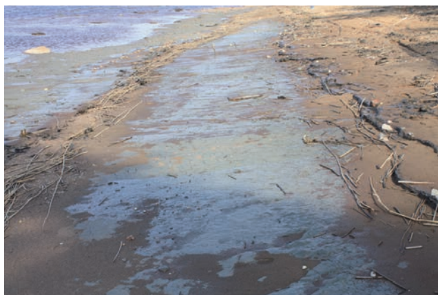
Рис. 61. а – выходы глин и зоны разгрузки подземных вод в приурезовой зоне пляжа к востоку от аварийного участка шоссе; б – результаты размыва берега осенними штормами 2013 г.
