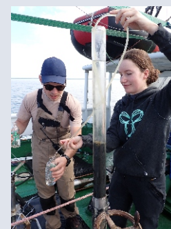
Отбор пробы на биогенный газ. Финский залив
