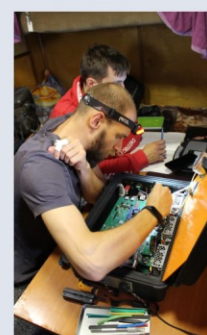
Ремонт сейсмостанции в полевых условиях
